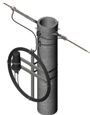
Рисунок 4.15.4 Устройство для подвеса муфты и хранения запаса ОКСН
