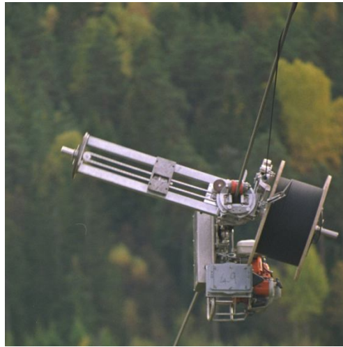
Рисунок 7.4.2 Навивная машинка шпиндельного типа
