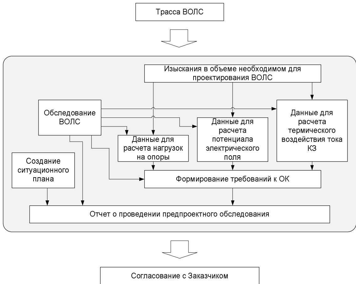
Рисунок 6.1.2 Структурная схема и порядок работы при предпроектном обследовании ВЛ
